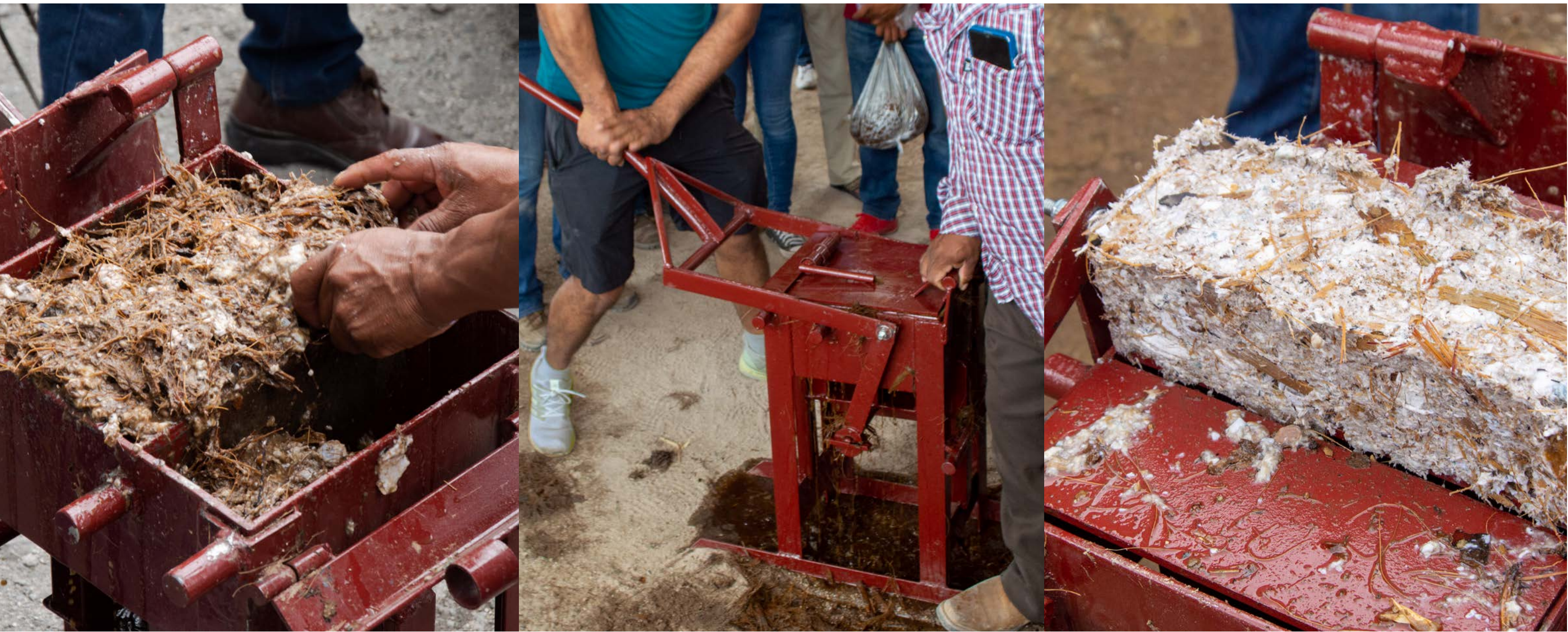
Proceso de prensado de briquetas en máquina briquetadora.
