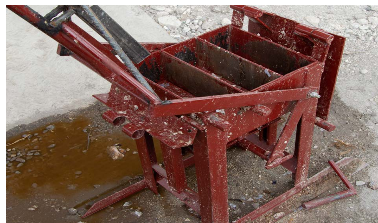
Máquina briquetadora. También se pueden usar moldes manuales
